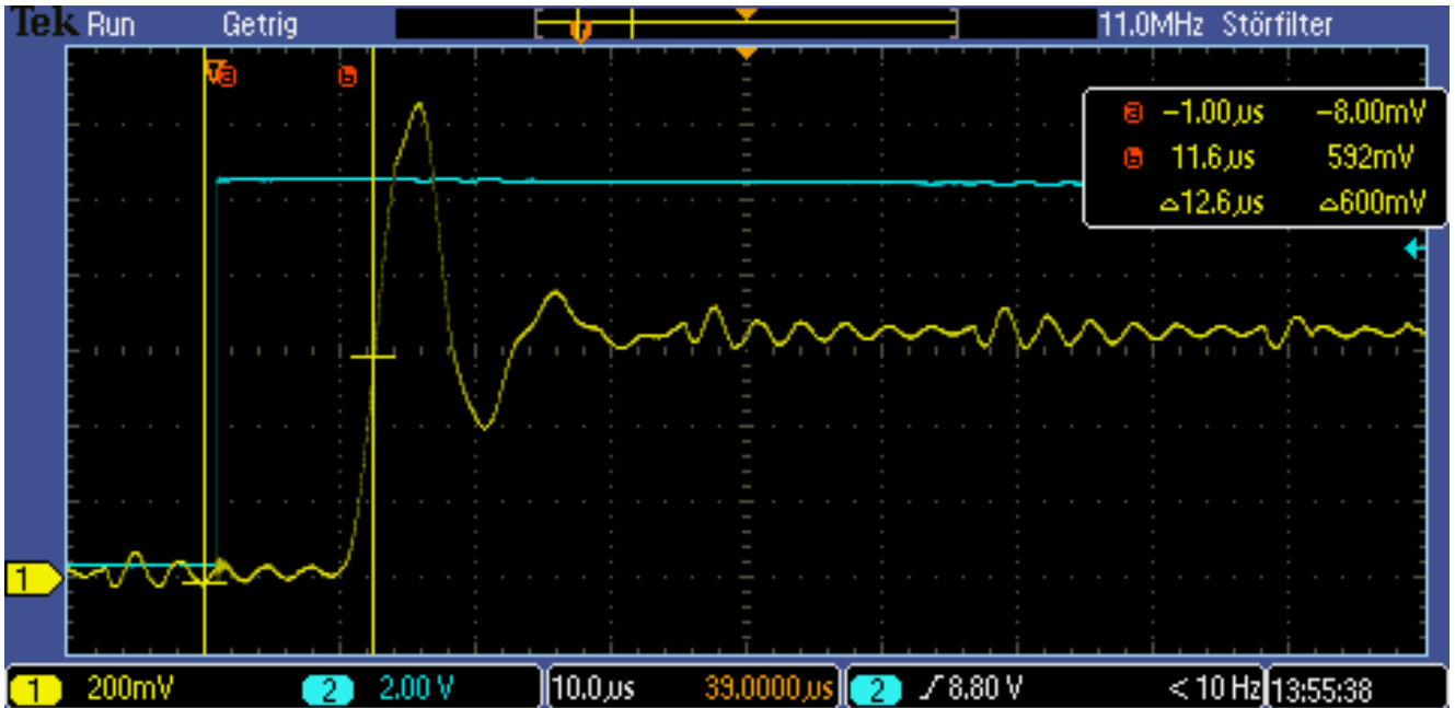
Abbildung 4: Dynamik nach Triggersignal S (5 A, 100 ms)
